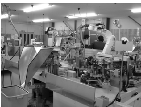
三川事業所の自動コイル巻きロボット
